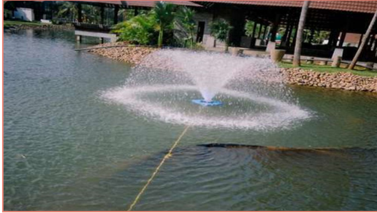
شکل ۹- دستگاه اسپلش (جهت هوادهی به کارمی رود)
